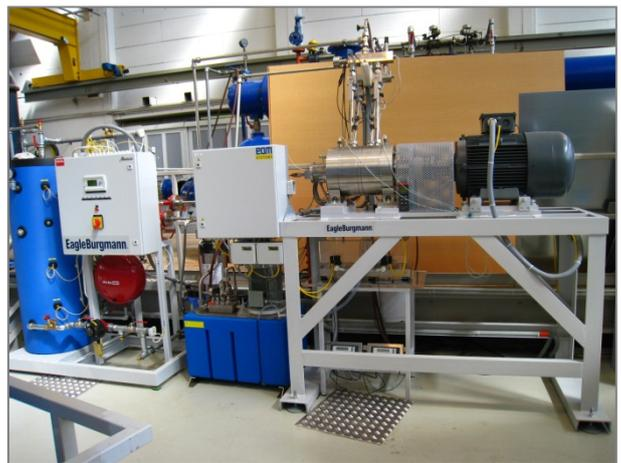
**Bild 2: Prüfstandsübersicht, links Kühlung, Mitte: Wasseraufbereitung (blau) – darüber Datenloggerschaltschrank, rechts Prüfling mit Antriebsmotor, darunter Leckagemessung**
