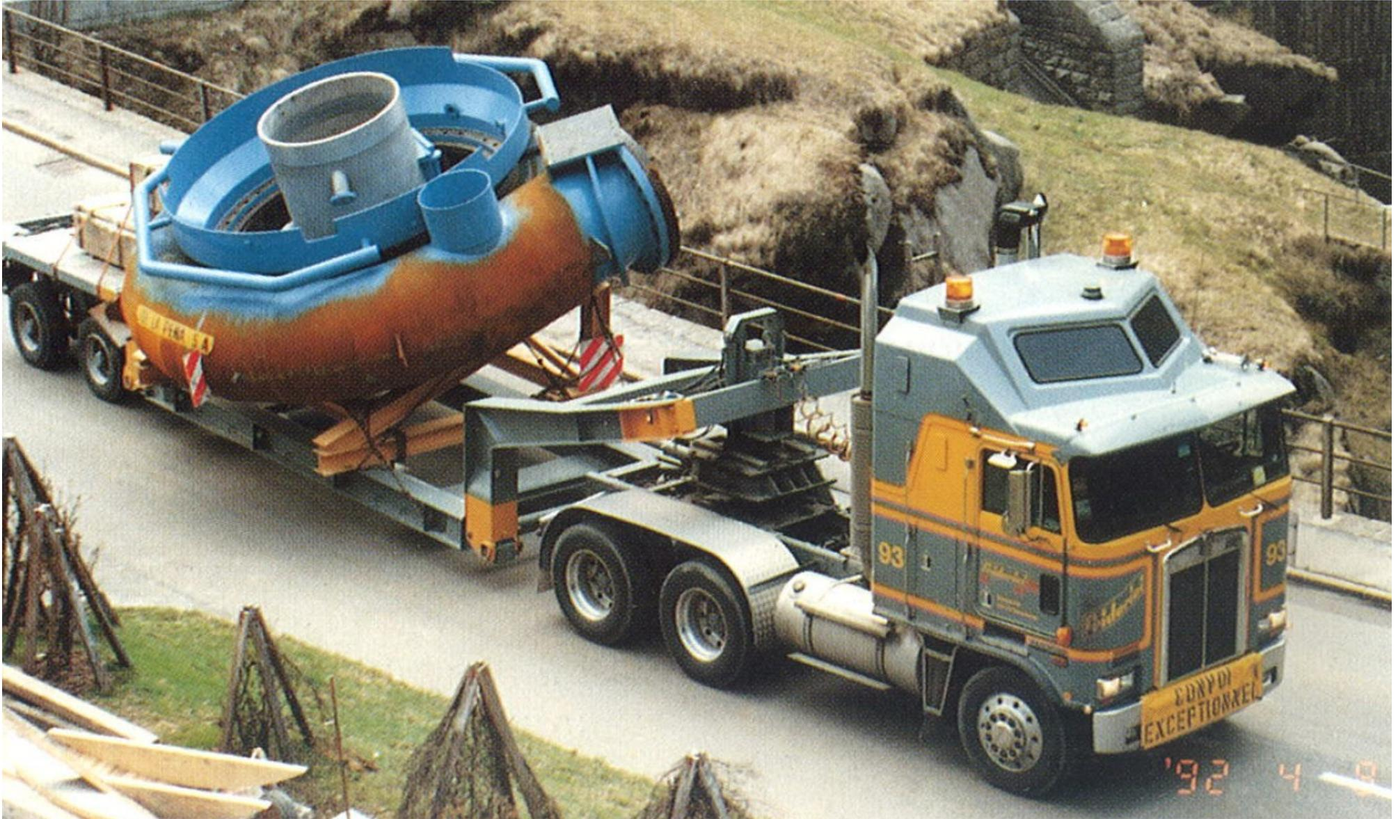
Kraftwerk Wassen, Schweiz – Transport des Spiralgehäuses
