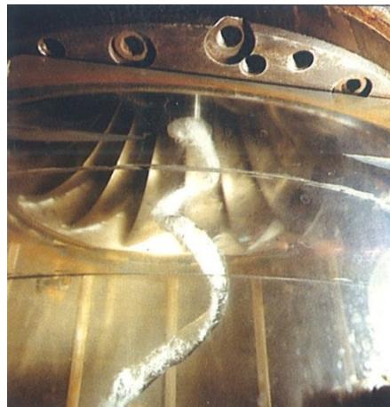
**Überlast:** stationärer Zopf in Saugrohrmitte
