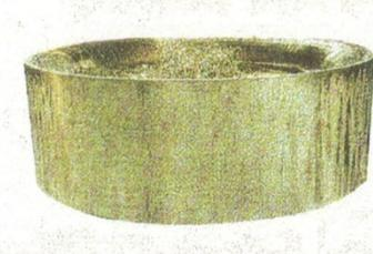
In den Grundkörper werden die Becherwurzeln gefräst, die durch das aufprallende Wasser besonders stark belastet sind.
