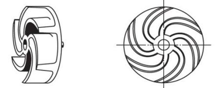
Freistromrad für Flüssigkeiten mit groben oder langfaserigen Feststoffen und Gas-einschlüssen
