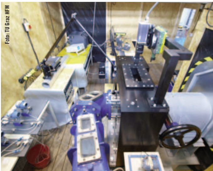
Abbildung 8: Laserkontrollbereich der institutsinternen durchgeführten PIV-Messung
