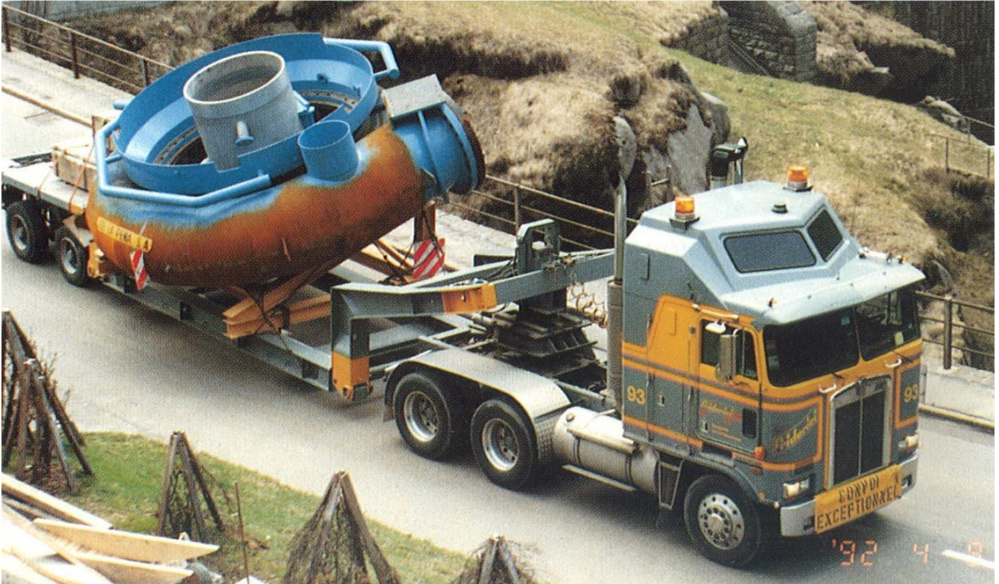
Kraftwerk Wassen, Schweiz – Transport des Spiralgehäuses
