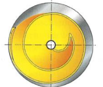
Abb. 16 Laufrad: offenes diagonales Einschaufelrad (O-Rad)
