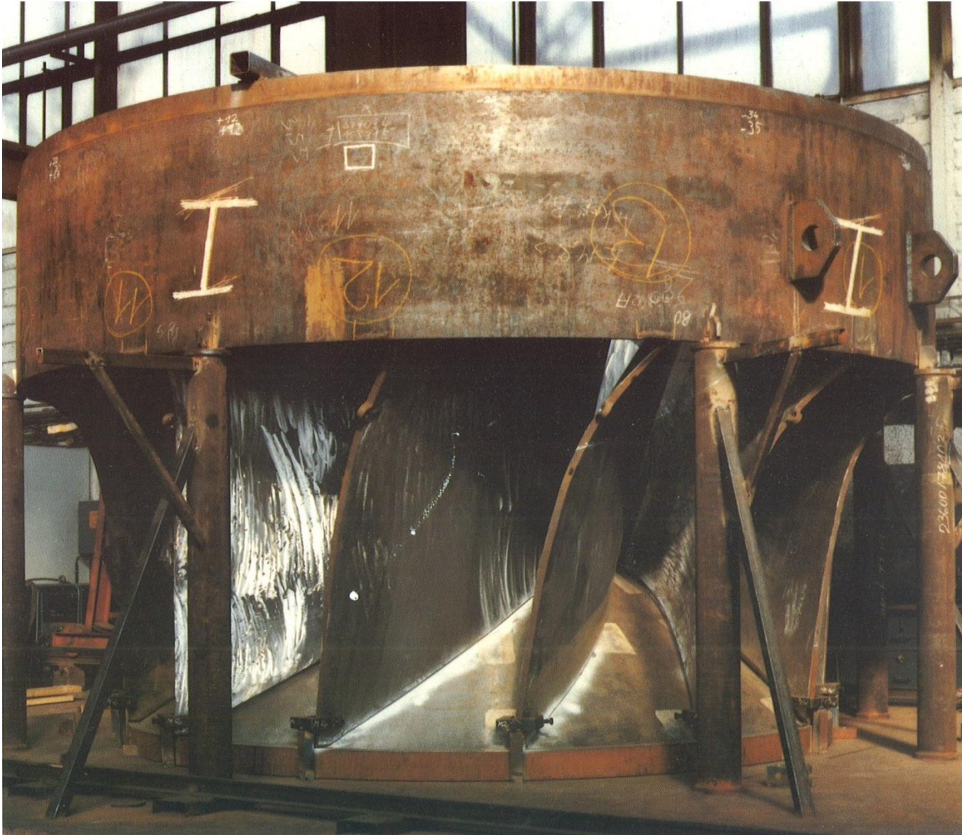
Zusammenschweißen von Laufkroneboden, Laufkronekranz, Schaufeln
